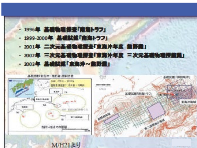
付図 12-渥美沖南海トラフにおける地震探査
